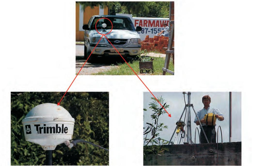
Figura 14.10 – Um sistema de DGPS tipo Pro XRS e 4.600 LS, Trimble, incluindo: um sensor DGPS montado em cima de um caminhonete, o DGPS e uma estação referencial fixada em uma torre de água localizada na CPAP/EMBRAPA. Fonte: (LIU et al., 2005).
