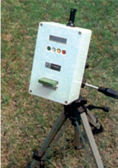
**Fig. 4.6** Fotômetro solar Cimel CE 317, utilizado em medições da irradiância solar direta
