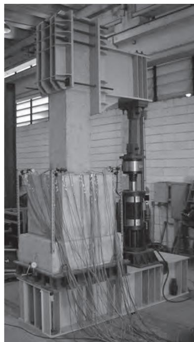
**Fig. 3.20** Exemplo de ensaio de ligação de pilar em cálice de fundação
