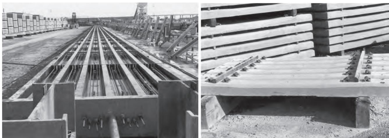
Fig. 16.10 Execução e armazenamento de dormentes monobloco
