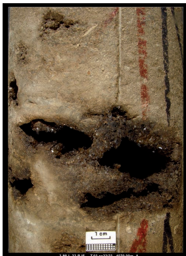
Figura 2. Amostra de testemunho de carbonatos albianos com porosidade vulgular, saturados de óleo, Bacia de Campos.
