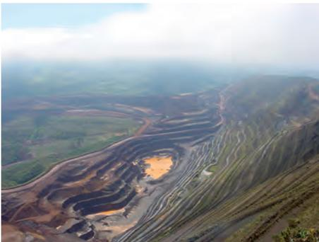
*Lavra por bancadas na mina de minério de ferro de Carajás (PA), com destaque para os taludes em processo de revegetação*
