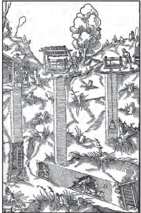
**FIG. 1.2** Ilustração representando o sistema de acesso ao subsolo nos primórdios da mineração subterrânea. (A), (B) e (C) são os poços verticais, e (D), a galeria
