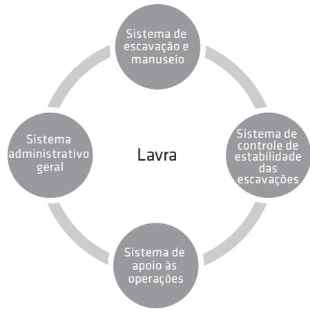
FIG. 1.6 Diagrama típico da lavra de minas com seus sistemas inter-relacionados
