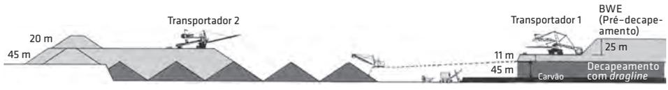
**FIG. 3.7** Lavra por tiras de uma camada de carvão (em negro) com pré-decapeamento utilizando mineradores contínuos combinado com dragline (à direita) e disposição do estéril em pilhas (à esquerda)
