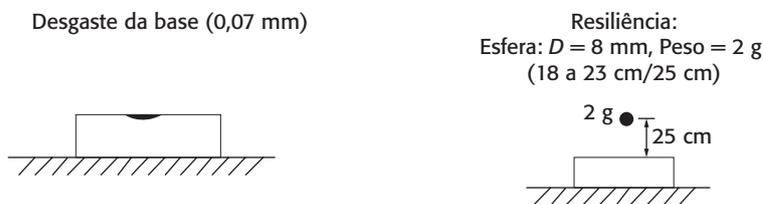
**Fig. 5.11** Verificação do aparelho de Casagrande
