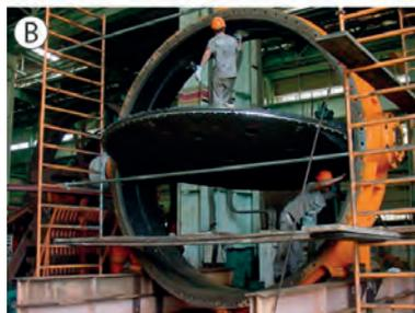
**Fig. 9.18** Válvula borboleta (A) fechada e (B) aberta em montagem
