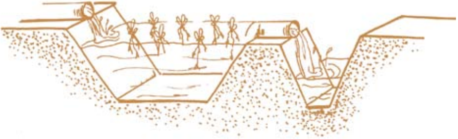
Fig. 1.2 Sistema baseado em macrófitas aquáticas flutuantes (enraizadas ou livres)
