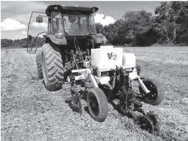
**FIG. 8.5** Plataforma U3, da Veris Technology, que integra sensores de condutividade elétrica aparente, pH e reflectância do solo
